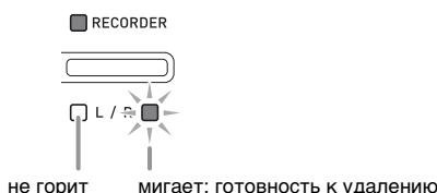
**4.** Еще раз нажать на кнопку «FUNCTION» и, не отпуская ее, нажать на кнопку «RECODER (L/R)».
